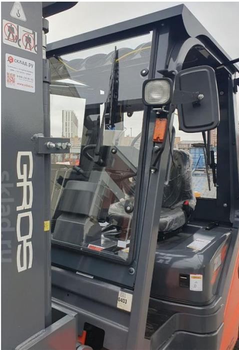
2) **Правая и левая двери** из углеродистой стали 2,5 мм, с **замком и ключом**, открывающимися сдвижными стёклами 4 мм с внутренней защёлкой, на газовых амортизаторах, уплотнителями и пр.
