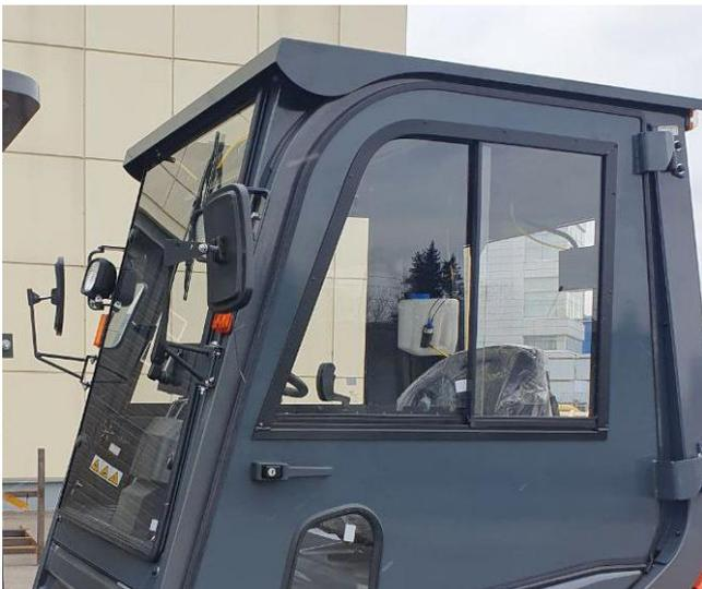
4) **Задняя панель** из углеродистой стали 2 мм, с **подъёмным стеклом** сталинит 5 мм на газовом амортизаторе, с внутренней защёлкой, **задний стеклоочиститель** в пластиковом кожухе с дворником и омывателем, уплотнители и пр.
