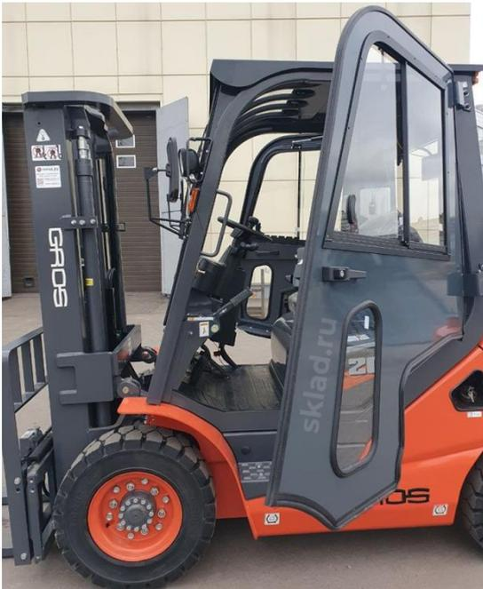
3) **Крыша** из 2 мм углеродистой стали, с **верхним окном** сталинит 5 мм.
